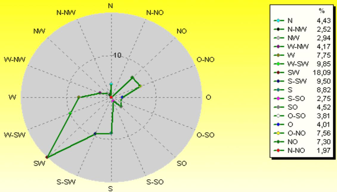
3095 / 1380 Werte -> 30.8% Windstille - Ø 9,7km/h - Max. 67,7km/h - 7248.4 km
